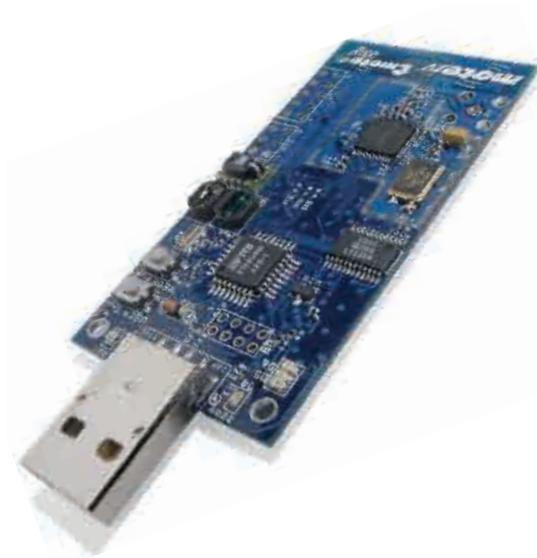
Sensor T-mote Sky, una de las posibles plataformas para instalar sensores medioambientales.
